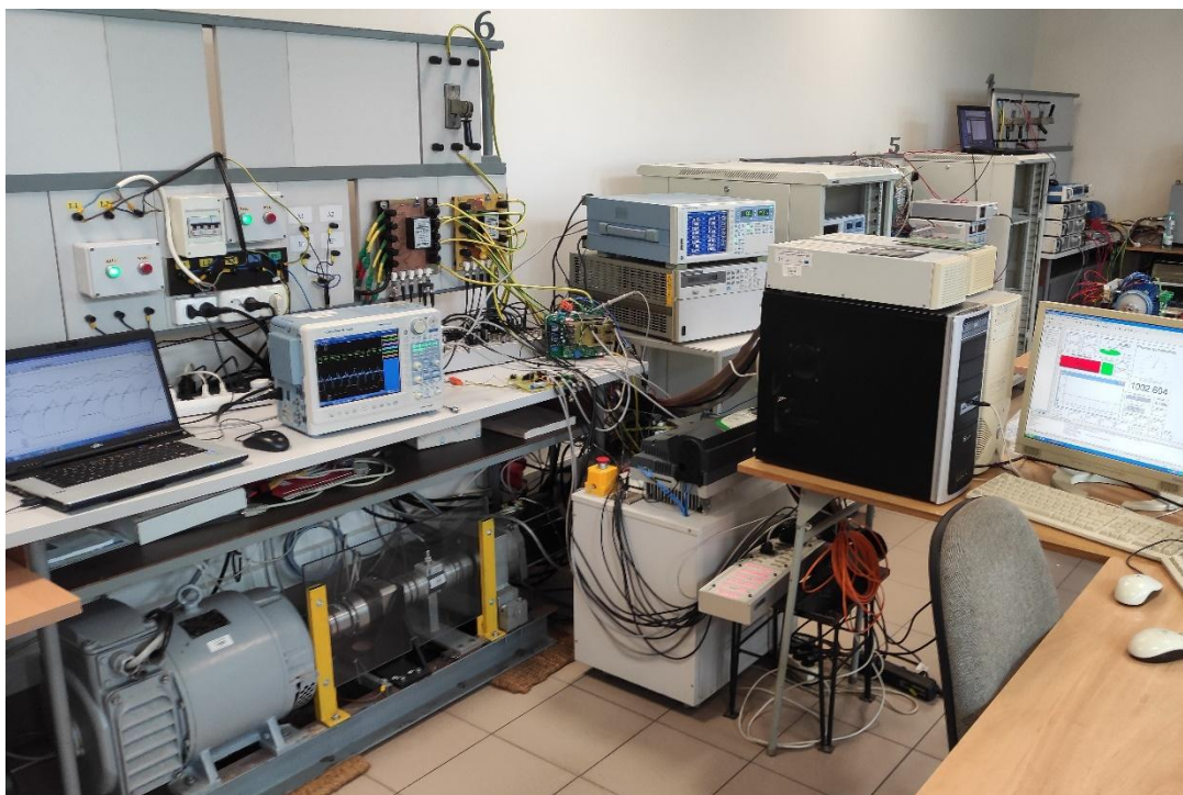
Rys. A.2. Widok ogólny stanowiska eksperymentalnego napędu SRM z proponowaną filtracją aktywną
