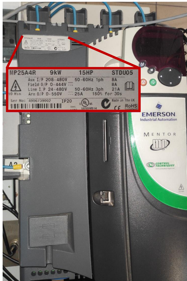
Rys. A.9. Sterownik hamowniczy prądu stałego
