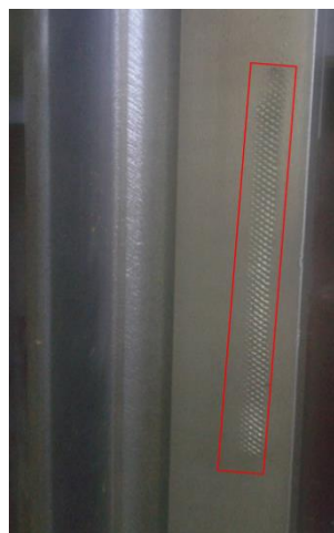
Rys. 4.13. Prowadnica typu T90/A: a) widok prowadnicy od góry z zaznaczoną na czerwono powierzchnią roboczą S , b) widok z plastycznie uszkodzoną powierzchnią roboczą
