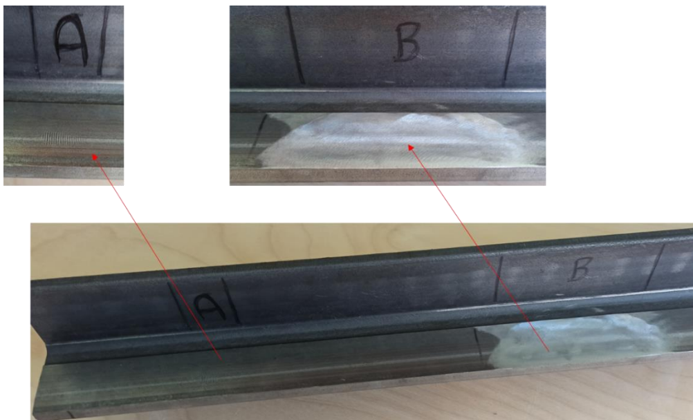
Rys. 4.18. Obszary deformacji plastycznej, wykonane w celu walidacji toru pomiarowego: A – ślad rolki hamującej chwytacza, B –obszar o znacznej powierzchni symulujący wyrównanie śladu po chwytaczu
