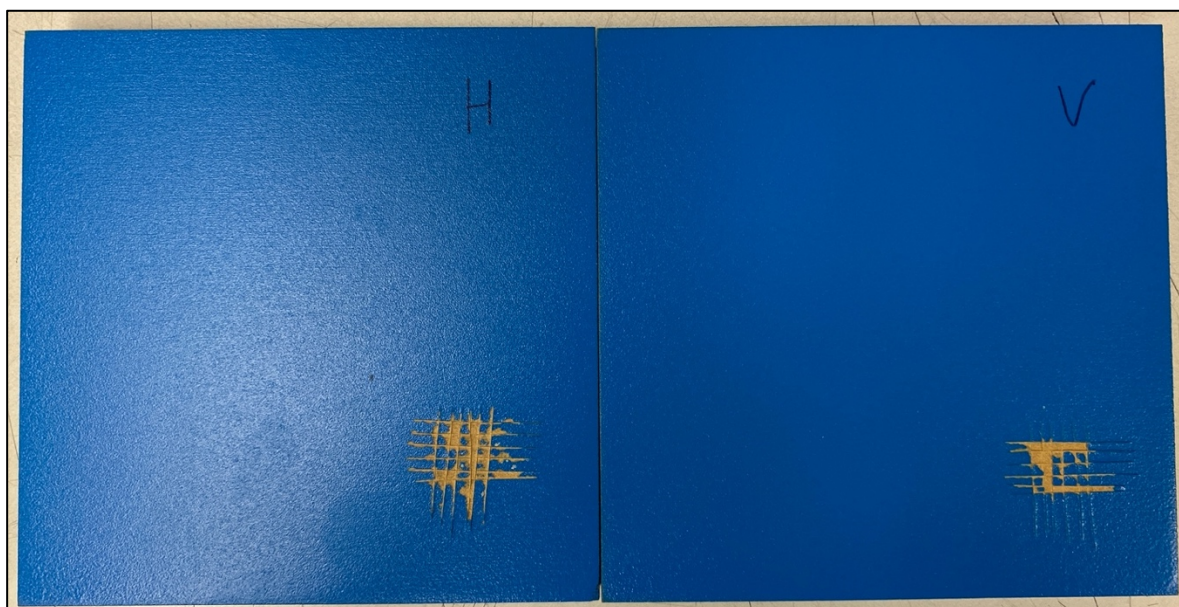
Rysunek 13. Próbki farby usieciowane za pomocą lampy typu H i V na MDF po badaniu przyczepności do podłoża
