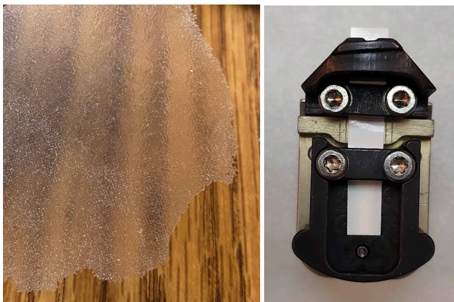
Rysunek 10. Powłoka proszkowa przygotowana do analizy DMA.
