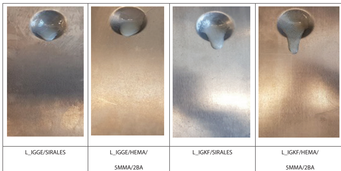
Rys. 3. Próbkki lakierów po przeprowadzeniu testu rozlewności
