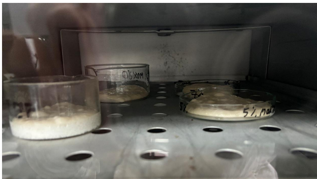
Rys. 79. Próbkę żelu zagęszczanego ścinaniem podczas polimeryzacji w suszarce z wymuszonym obiegiem.
