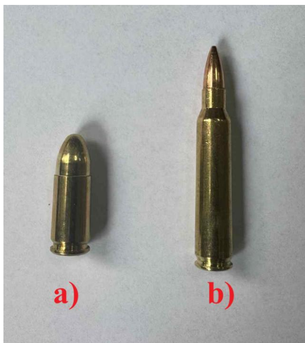
Rys. 108. Wygląd wykorzystanych do badań poligonowych pocisków: a) 9 \times 19 mm Parabellum oraz b) 5,56 \times 45 mm NATO.
