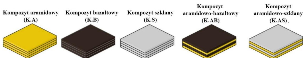
Rys. 34. Budowa struktury wzmocnienia otrzymanych kompozytów wzmocnionych tkaninami: aramidowymi (kolor żółty), bazaltowymi (kolor ciemnobrązowy) oraz szklanymi (kolor jasnoszary) [164].
