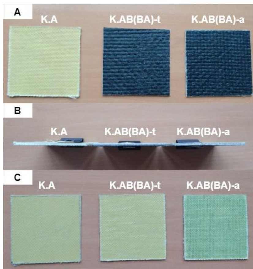
Rys. 47. Wygląd próbek użytych w teście przebicia udarowego: A – kompozyt aramidowy, B – kompozyt aramidowo-bazaltowy z warstwami ułożonymi grupowo, C – kompozyt aramidowo-bazaltowy z naprzemiennie ułożonymi warstwami [259].
