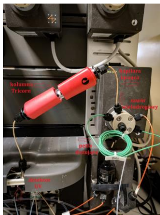
Rys. 2.4. Droga elucji w zestawie chromatograficznym z zamontowaną kolumną
