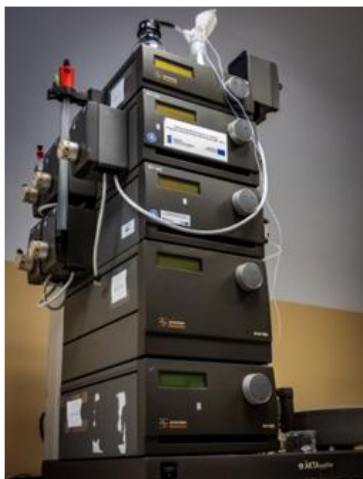
Rys. 2.1. Ilustracja zestawów chromatograficznych użytych do badań A) Chromatograf cieczowy Äkta Purifier. B) Chromatograf do SEC firmy Thermo Fisher Scientific. Opracowanie własne
