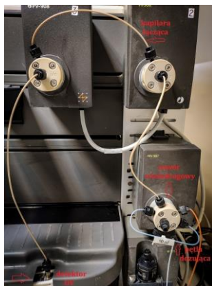
Rys. 2.2. Zestaw eksperymentalny ECV z opisanymi elementami drogi elucji
