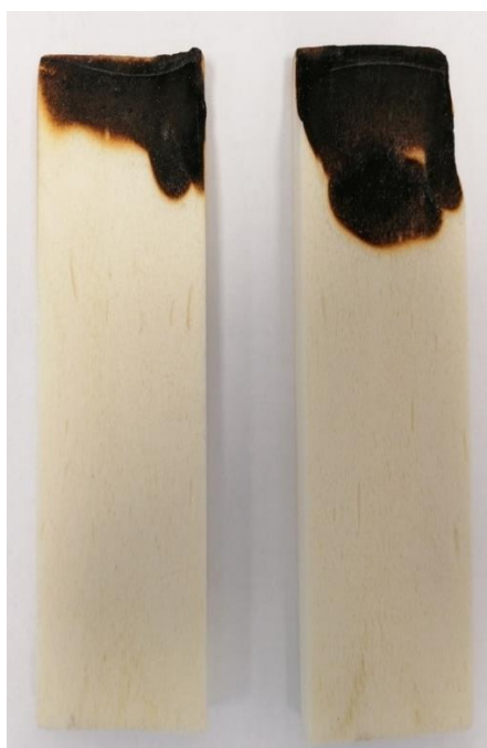
Rysunek 57. Badanie palności metodą testu poziomego pianki otrzymanej z polioliu H_3PO_3 -GDE-HPC-GL-WE
